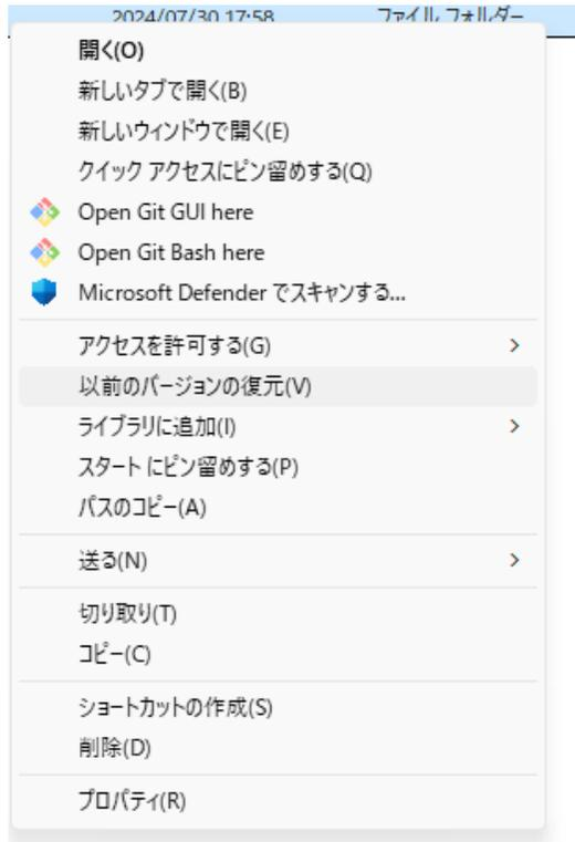
Stable Diffusion WebUIのデータを格納する任意のフォルダを開きます。開いたフォルダ内で、右クリックして、[Open Git Bash here]をクリックしてターミナルを開きます。開いたターミナルに下記コマンドを入力し、“Enter”を押します
